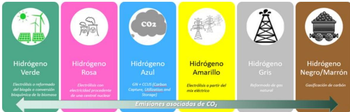
Figura 16 - Principales métodos de obtención de hidrógeno [18]
