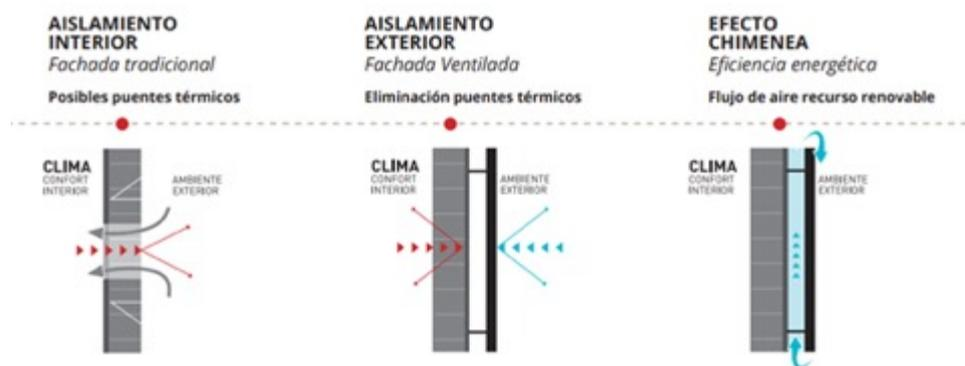
*Ilustración 1: Efecto chimenea en fachadas ventiladas*
