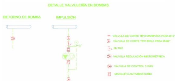
*Ilustración 3: Detalle valvulería en bombas*
