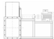
Accionamiento por acoplamiento elástico, turbina montada en el eje soporte, montado al motor mediante acoplamiento elástico. Todo montado conjuntamente sobre la sileta ventilador.
