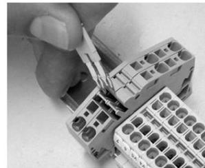
Retire el puente para desactivar un calentador (reducción de 300 W)
