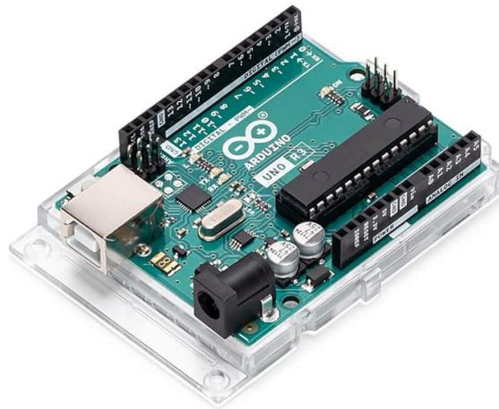
Figura 4.2. Placa Arduino Uno R3 utilizada como unidad de control y adquisición del sistema [30]
