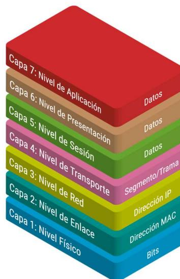
*Ilustración 4. Capas del modelo OSI [8]*
