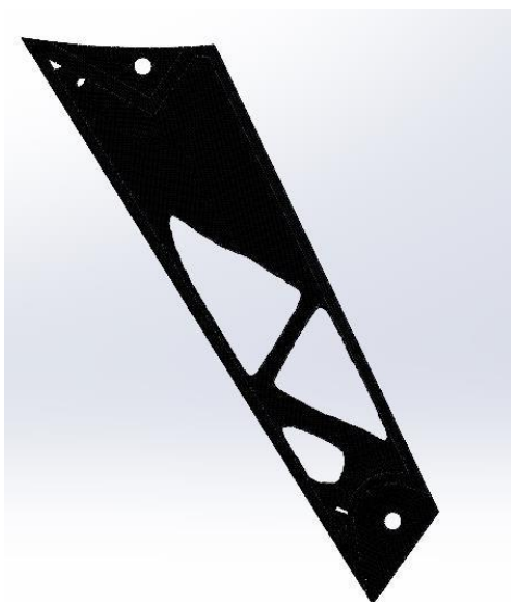
Figura 64. Malla optimizada para chapa del soporte inferior.
