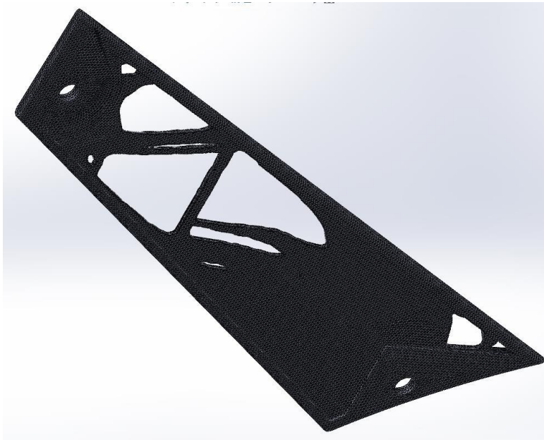
Figura 65. Malla optimizada para impresión 3D del soporte inferior.
