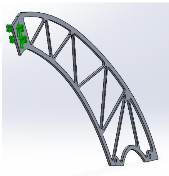
Figura 46. Representación de las sujeciones en estudios de frecuencia.
