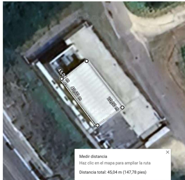
Figura 18: Medidas cubierta ATI de Madriñán. pk:49+125
