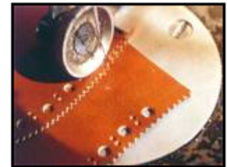
3: Tras pegar el contrafuerte a la cañeta, apara ambas piezas
