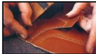
2: A continuación, el aparador fija la empella a la cañeta.
