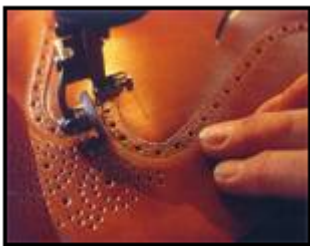
1: La base de la empella y la empella se aparan conjuntamente.
