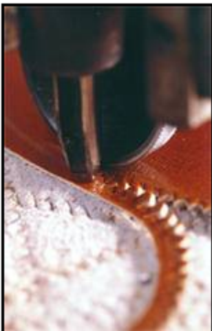
Se afilan los bordes que se deben unir mediante costuras.
