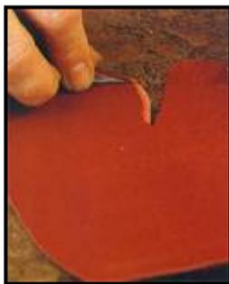
Se afilan los bordes que se deben unir mediante costuras.
