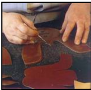
Se marcan los puntos del respunteado
