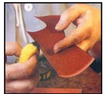
Se tiñen las superficies cortadas.
