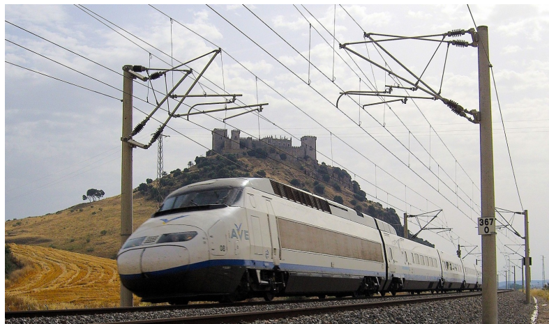
Figura 2.1: Sistema de alimentación eléctrica mediante Catenaria
