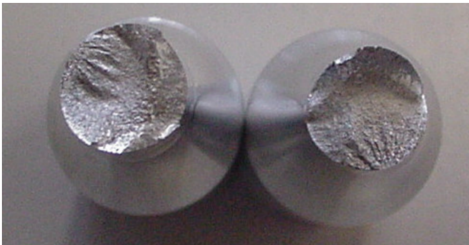
Figura 6.1: Ejemplo de rotura por fatiga.
