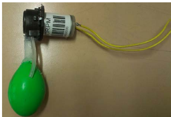
Figura 4.7. Bomba de agua usada con el depósito ya conectado a ella.
