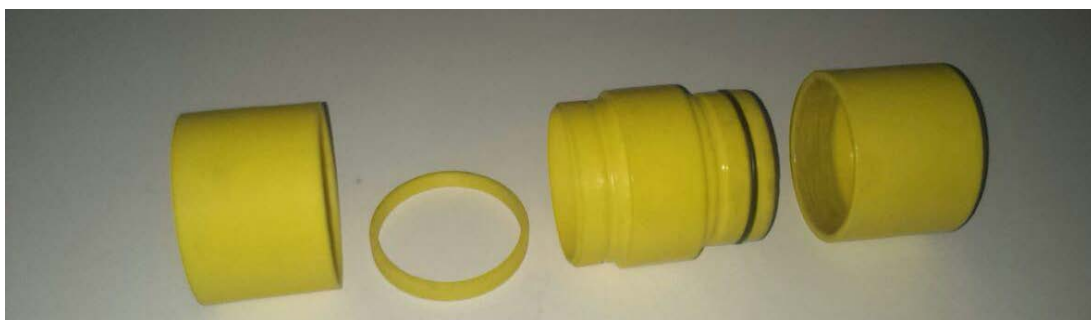
Figura 3.10. Prototipo de juntas tóricas impreso. Nótese la rotura en la parte izquierda.
