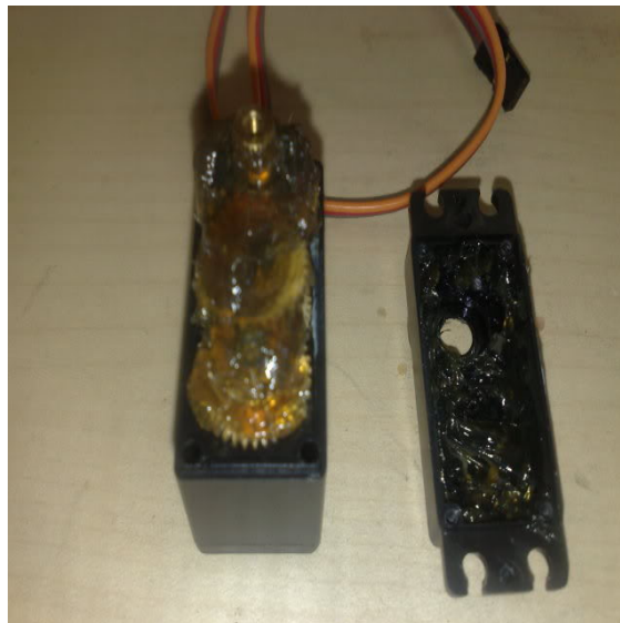
Figura 4.1. Servo impermeabilizado mediante grasa.
