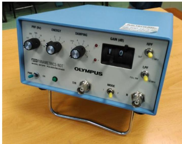
Figura 17. Pulsador receptor controlado manualmente Olympus 5072PR
