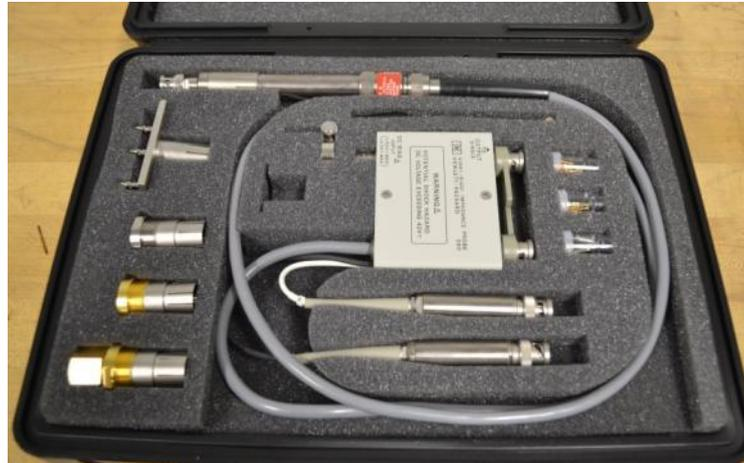
Figura 28. Impedance probe kit HP 4194A (fuente: <http://www.cal-center.com>)
