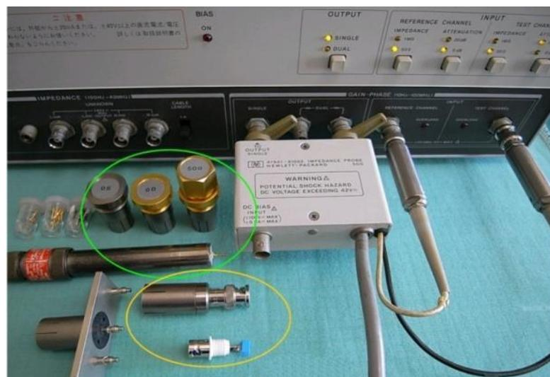
*Figura 32. Conexión de la sonda y patrones de calibración (fuente: <http://www.geocities.jp>)*
