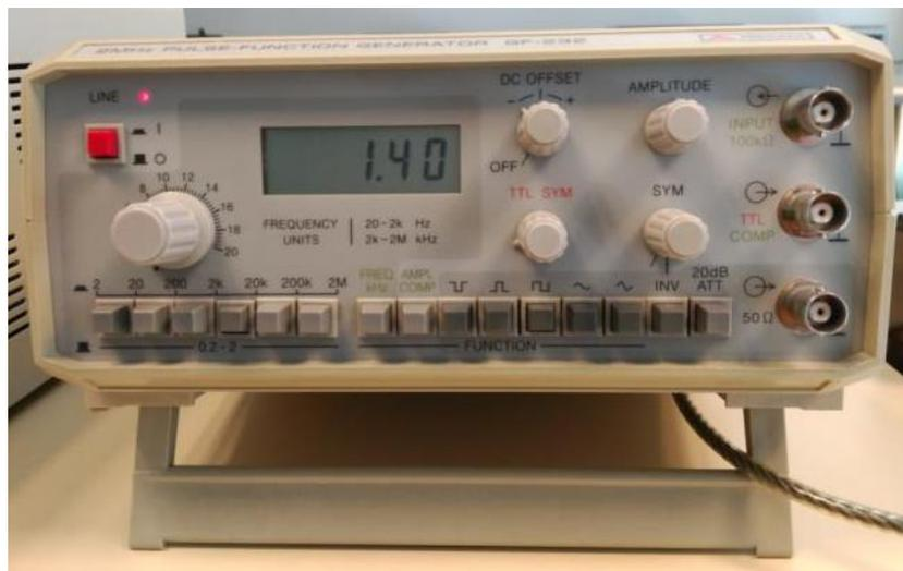
Figura 29. Generador de funciones GF-232
