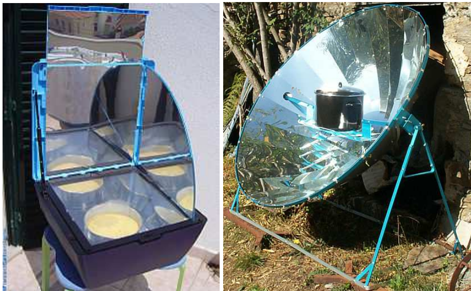
Figura 8. (a) Ejemplo de cocina de caja comercial con espejos exteriores abatibles e interiores de segmento de parábola. El espejo lateral sirve de generador de sombra para controlar la duración de la cocción. Fuente: http://en.wikipedia.org/wiki/File:Solar_oven_Portugal_2007.jpg . (b) Cocina parabólica tipo SK14, con reflector profundo pseudo-paraboloidal de revolución. Fuente http://en.wikipedia.org/wiki/File:ALSOL.jpg .
