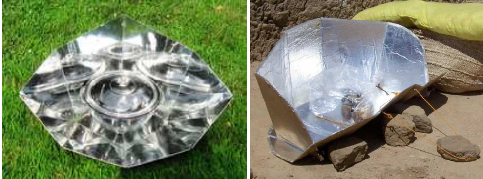
Figura 9. (a) Cocina con reflectores de panel y tapa, moldeados en vidrio, a modo de cobertor provocando efecto invernadero, ya que encierran la olla, capacidad 5 litros, fuente: http://en.wikipedia.org/wiki/File:HotPot_d.PNG by Paul Arveson, June 27, 2011. Origen: http://www.she-inc.org/hotpot-1.php . (b) Cocina de panel tipo Cookit construida con cartón corrugado y lámina de aluminio, con olla protegida por bolsa de plástico inflada, resistente al calor, a modo de cobertor, fuente: http://solarcooking.wikia.com/wiki/CooKit añadida por Tom Sponheim procedente de CooKitIridimi Refugee Camp.
