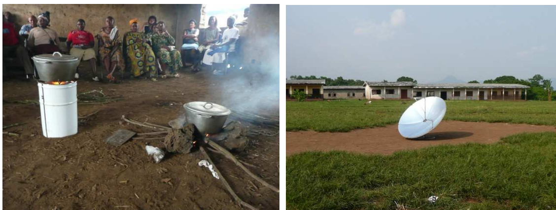
Figura 7. Demostración por parte de la fundación Sol Solidari en Camerún en 2010. a) Cocina mejorada frente a cocina tradicional de tres piedras en el suelo; b) Cocina solar parabólica de foco somero comercial, basada en antiguas antenas parabólicas de chapa, con la superficie cubierta de cinta adhesiva aluminizada, de origen chino. Con permiso de los autores.
