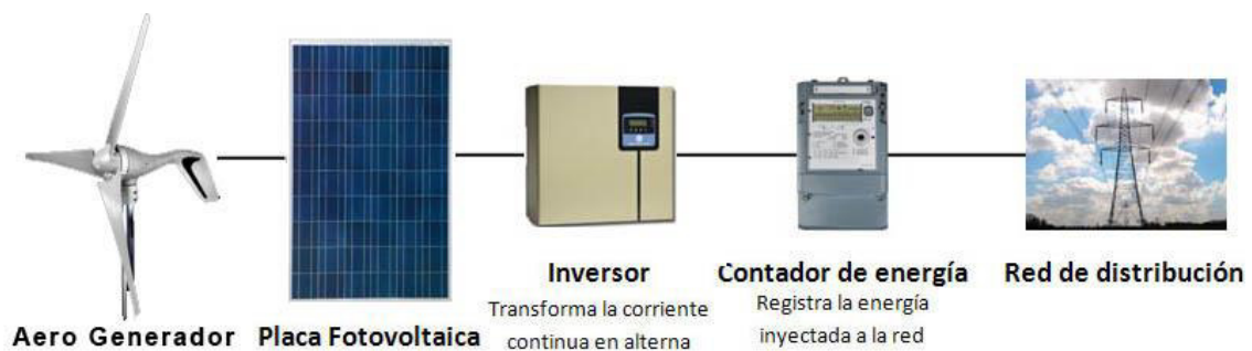
Figura 22. Sistema conectado a la red eléctrica.
