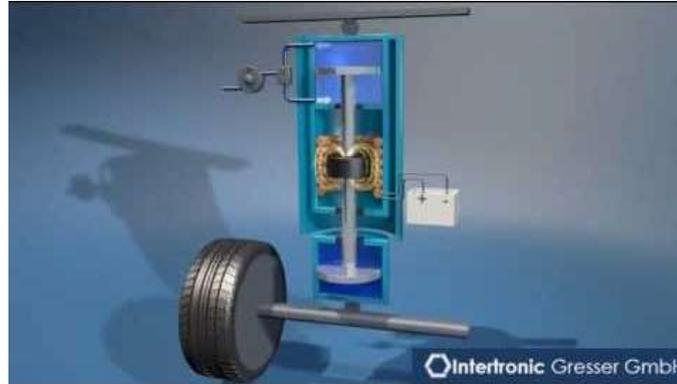
FIG. 2.14: SUSPENSIÓN REGENERATIVA ELECTROMAGNÉTICA LINEAL PROPUESTA POR INTERTRONIC GRESSER GMBH
