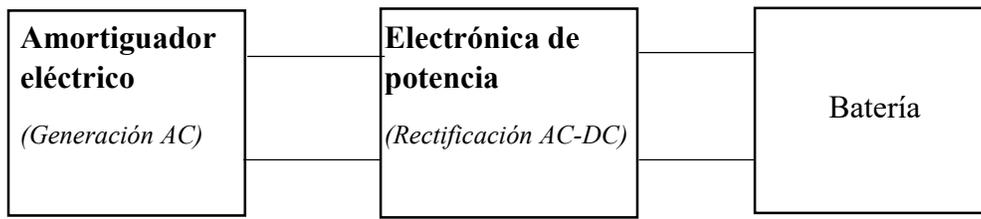
FIG. 5.6: DIAGRAMA DEL SISTEMA DE SUSPENSIÓN REGENERATIVA
