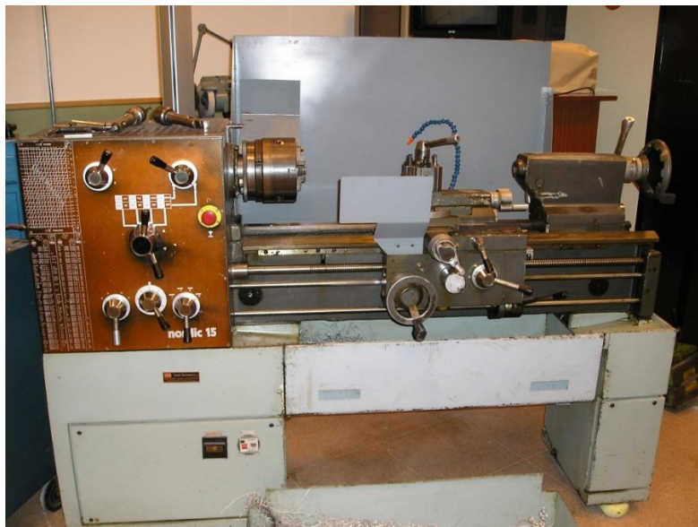
ILUSTRACIÓN 24 - TORNO PARALELO CONVENCIONAL
