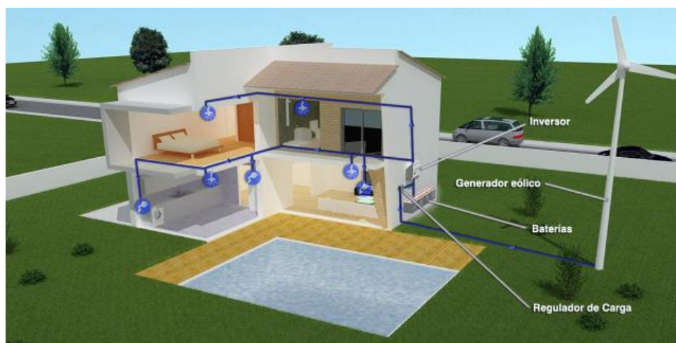
Ilustración 48: El Net Metering permite devolver energía a la red
