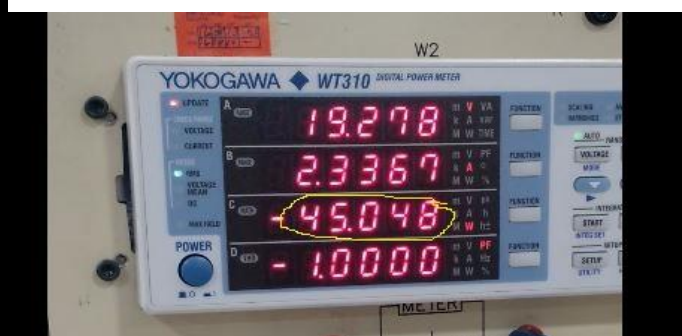
Ilustración 41: Medidas a la salida del rectificador
