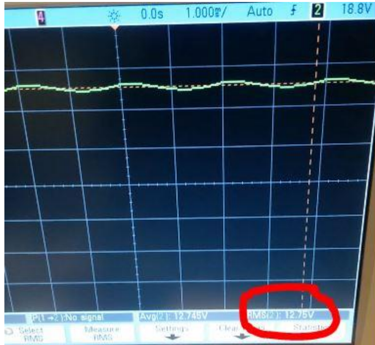
Ilustración 44: Medida del osciloscopio a la salida del conversor
