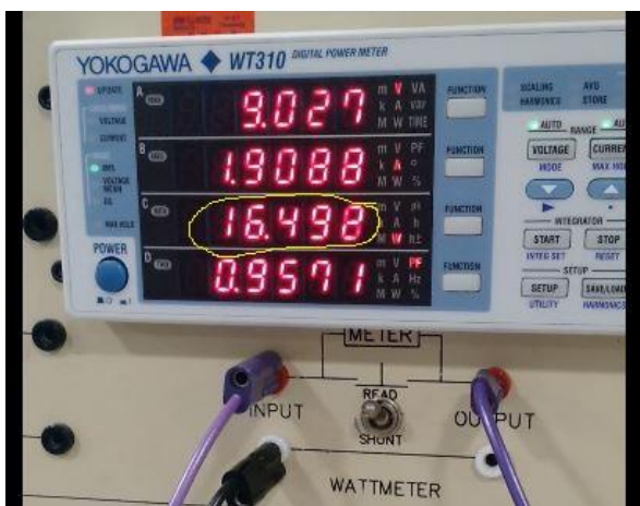
Ilustración 40: Medidas a la entrada del rectificador
