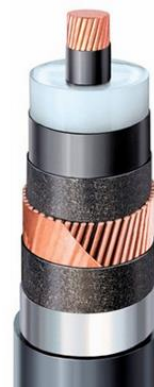
Imagen 4. Ejemplo de cable aislado seco, cableado en alambres de cobre, pantalla en forma de hilos. Distribuido por Abelma Chile. Fuente: (ABEL__)
