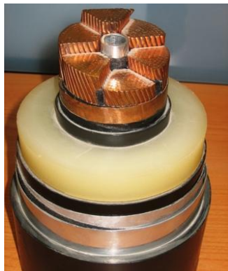
Imagen 3. Ejemplo de cable aislado OF, tipo Milliken, aislamiento XLPE. Fabricado por PRYSMIAN. Fuente: (PRYS12)
