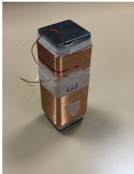
Fig. 2.1 Imagen del electroimán
