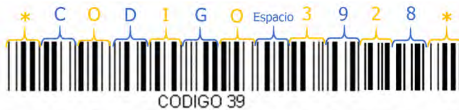
Figura 2.3. Ejemplo de un código de barras tipo Code 39. Modificado de [Wwwt].
