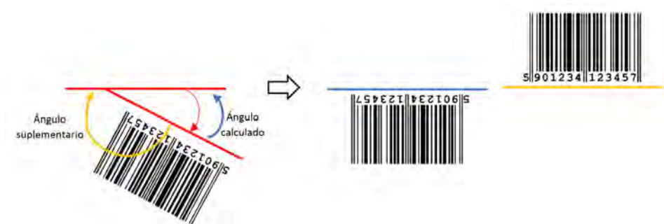
Figura 4.16. Ejemplo de las dos rotaciones: la del ángulo calculado en azul y la del ángulo suplementario en amarillo. Modificado de [Wwwap].
