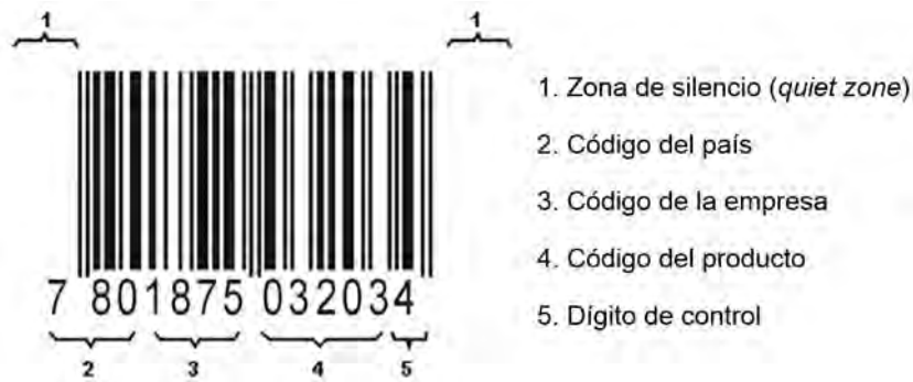
Figura 2.1. Estructura del código de barras EAN-13. Modificado de [Wwwad].
