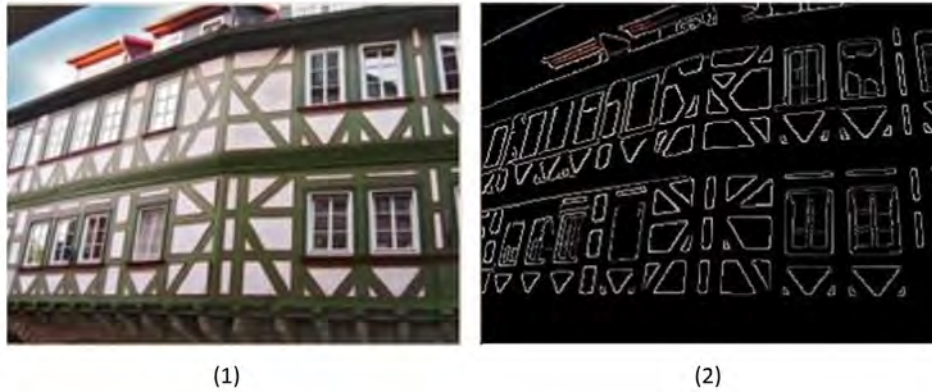
Figura 3.11. Ejemplo de detección de bordes mediante Canny. (1) Imagen original. (2) Imagen tras haber aplicado la técnica de detección de bordes Canny. Modificado de [Wwww].
