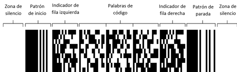
Figura 2.5. Estructura del código PDF 417. Modificado de [Wwwwav].
