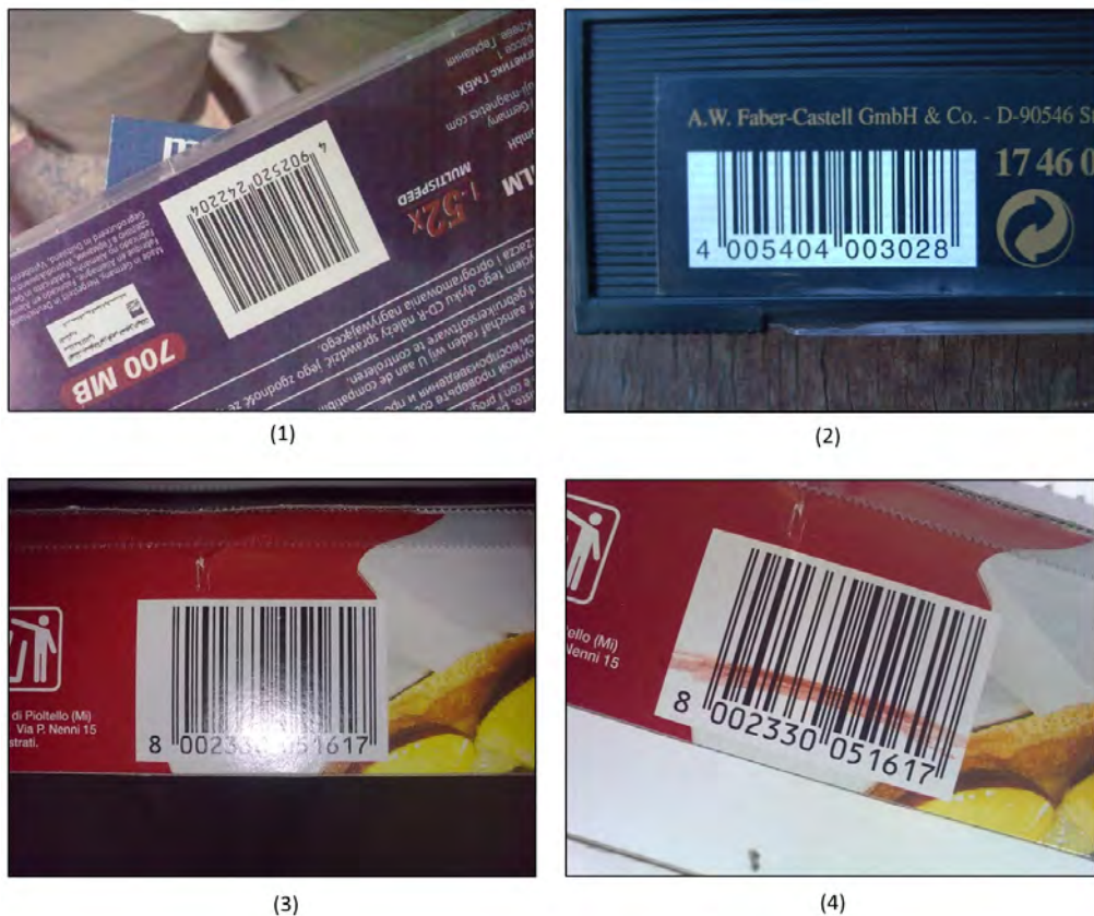
Figura 6.2. Ejemplos de imágenes con distintas condiciones de iluminación y orientación de los códigos. (1) Buena iluminación y orientación distinta a la de por defecto. (2) Buena iluminación y orientación por defecto. (3) Mala iluminación y orientación por defecto. (4) Imagen con defecto en el código.
