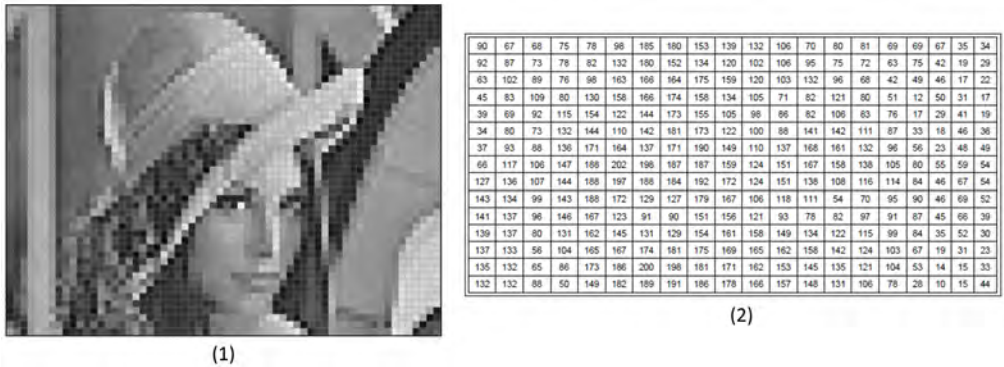
Figura 4.1. Ejemplo de imagen en escala de grises. (1) Píxeles de la imagen. (2) Matriz con valores de los píxeles. Modificado de [Wwwak].
