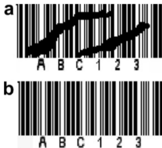
Figura 3.20. Técnica para adecuar líneas. (a) Imagen original, (b) Imagen tras la corrección. Modificado de [YS07].
