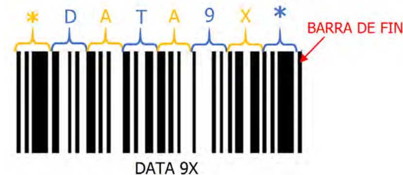
Figura 2.4. Ejemplo de un código de barras tipo Code 93. Modificado de [Wwwg].
