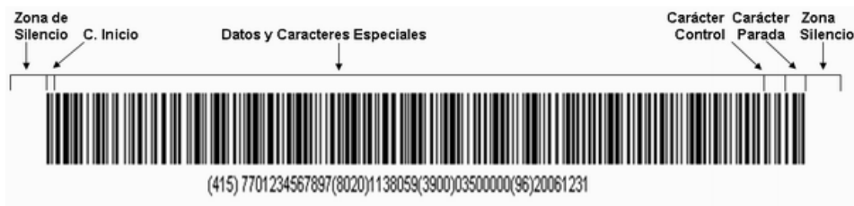
Figura 2.2. Estructura del código de barras Code 128 [Wwwt].
