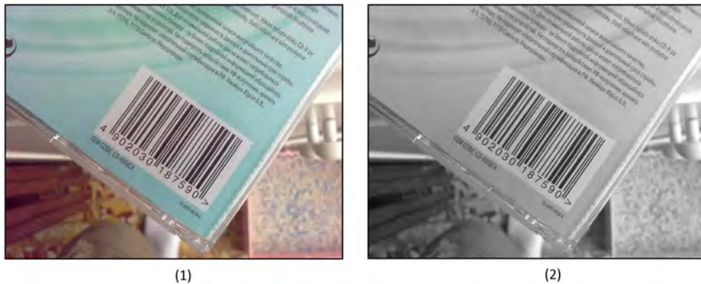
Figura 4.3. Conversión de una imagen en color a escala de grises. (1) Imagen original. Obtenida de la base de datos no.2 plain [Wwwp]. (2) Imagen en escala de grises.
