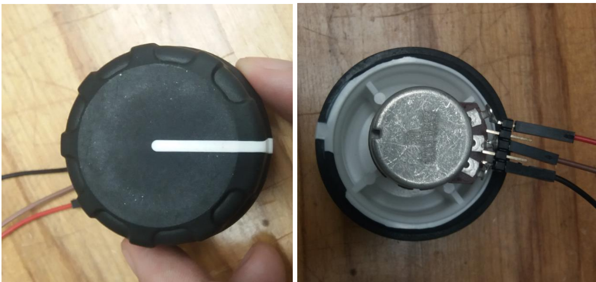
Figura 14: Vistas de la planta e inferior del potenciómetro lineal
