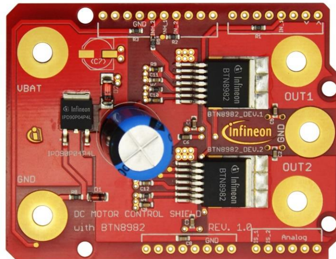
Figura 11: Placa de control de motor DC con BTN8982TA de la marca infineon
