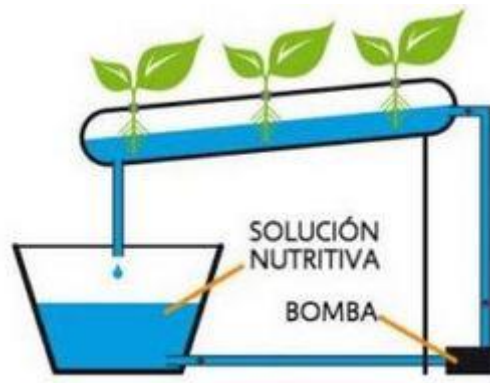
Figura 19: Representación del sistema hidropónico de NFT sacada de [21]
