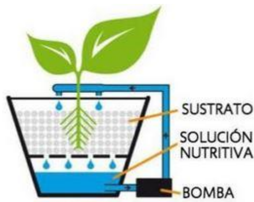
Figura 17: Representación del sistema por goteo sacada de [21]
