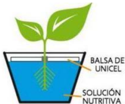
Figura 16: Representación del sistema hidropónico de raíz flotante sacada de [21]
