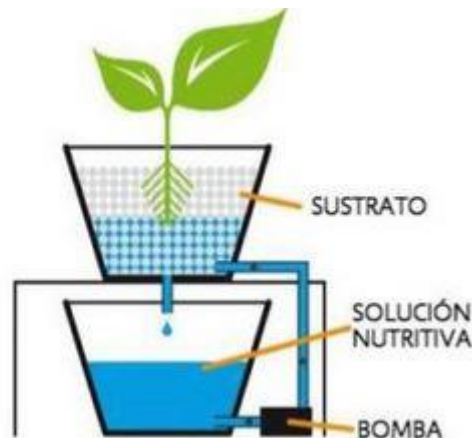
Figura 14: Representación del sistema hidropónico de flujo y reflujo sacada de [21]
