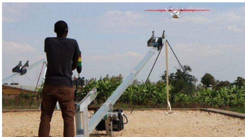
Ilustración 5: Mecanismo de despegue de Zipline (fuente: Zipline)
