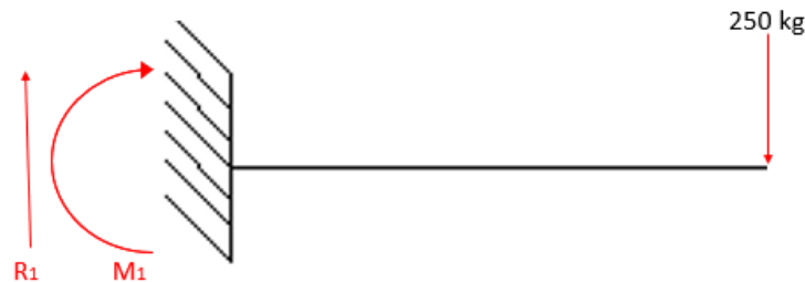
Ilustración 29: Diagrama de fuerzas y momentos aplicados en el subchasis
