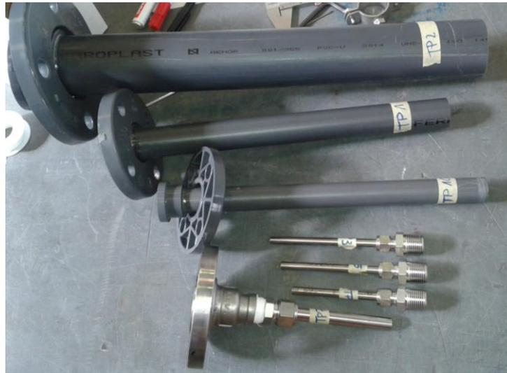
*Figura 5. Detalle de las conexiones de los TPs que se envían por separado*
