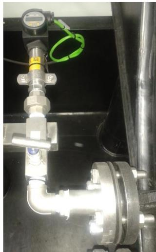
*Figura 18. Detalle del transmisor de presión*
