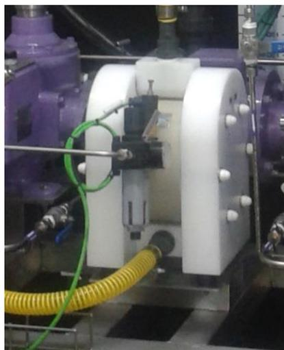
*Figura 14. Detalle de la bomba neumática*
