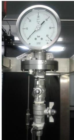
*Figura 22. Detalle de un manómetro de alta presión*
