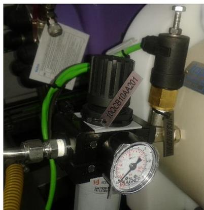
*Figura 23. Detalle del filtro regulador y el presostato*
