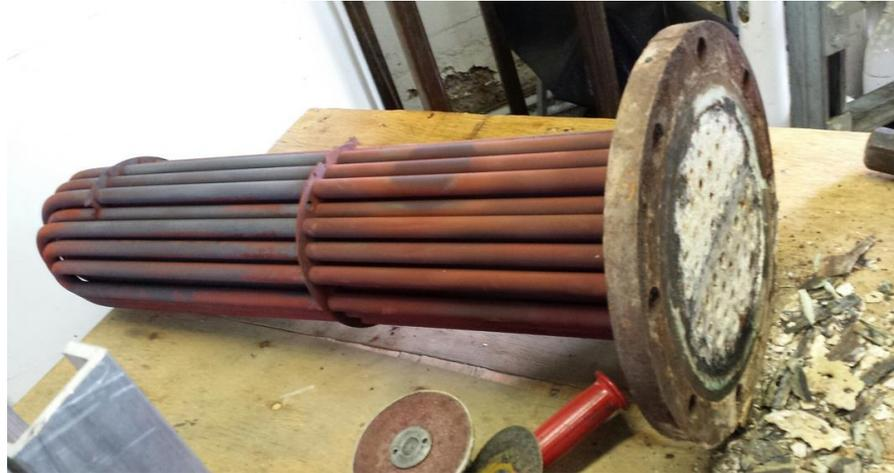
*Figura 3. Corrosión en el haz de tubos de la caldera*
