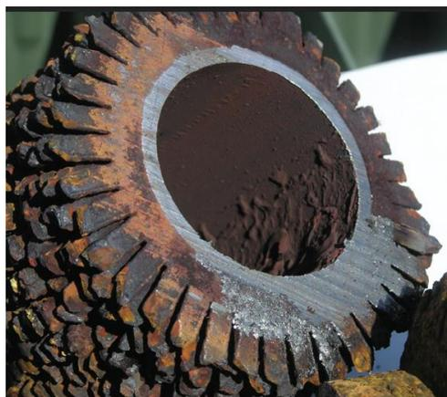
*Figura 2. Corrosión en un tubo del calentador de agua de alimentación del HRSG*
