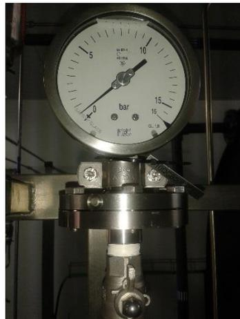
*Figura 21. Detalle de un manómetro de baja presión*
