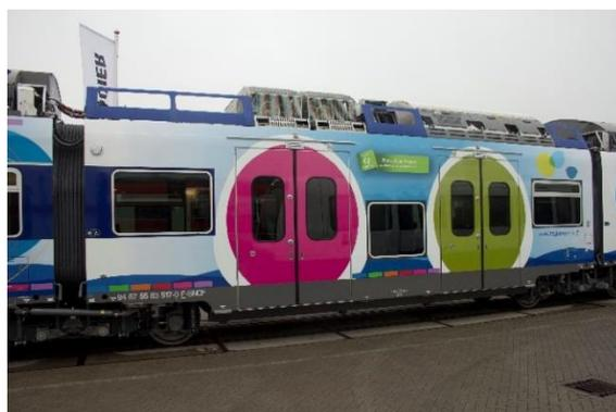
Figura 26. Exterior del tren OMNEO. Coche de un único piso con dos puertas dobles y piso bajo. Arquitectura articulada.
