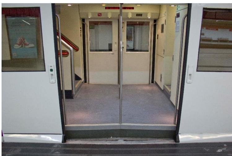
*Figura 19. Serie 450. Tren de dos pisos. Escalón a la entrada que impide la accesibilidad universal. Espacio pequeño para poder acceder a los dos pisos.*
