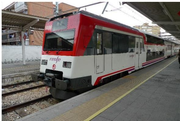
*Figura 14. Serie 446. Exterior del tren. Dos puertas dobles por coche. Dificultad de acceso entre puerta y andén para personas con movilidad reducida.*
