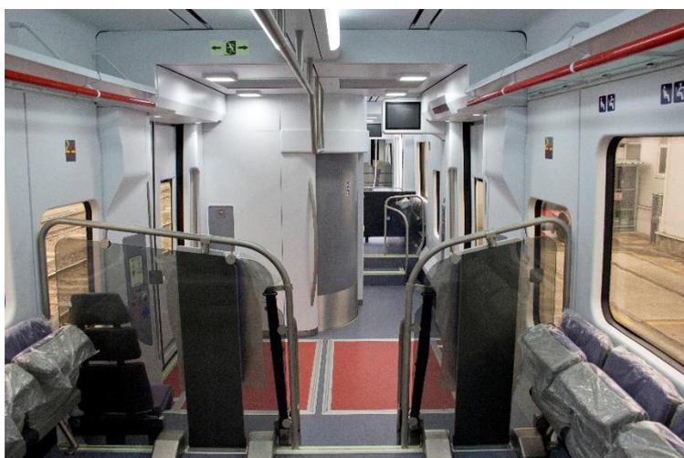
*Figura 18. Serie 447. Reformada con espacios para personas de movilidad reducida. Colocación de asientos transversales.*
