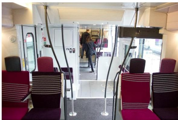
Figura 30. Interior del coche de un piso. Huecos para la multimodalidad (bicicletas). Agarraderas verticales próximas a la puerta. Estructuras de cristal para separar zonas.
