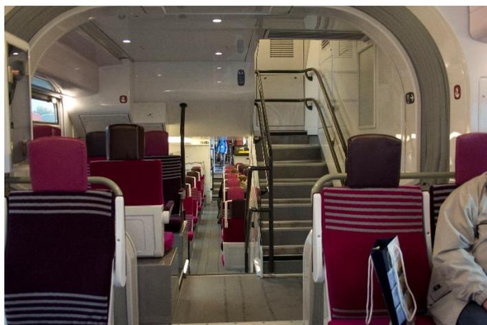
Figura 29. Interior del tren OMNEO. Escaleras de subida y bajada en el piso de dos plantas. Posición de los asientos longitudinal.
