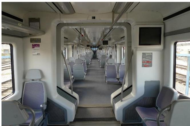
Figura 23. CIVIA. Paso diáfano entre coches. Distribución de asientos tanto en forma transversal como longitudinal. Asientos en voladizo. Facilidad para la limpieza.
