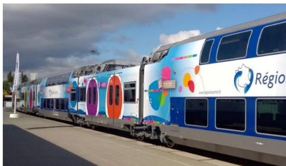
Figura 25. Exterior del tren OMNEO. Composición formada por piso doble más piso único.
