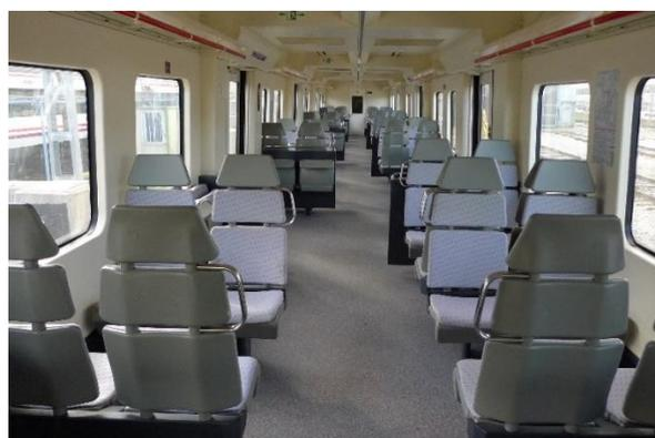
*Figura 15. Serie 446. Distribución interior. Asientos longitudinales sin ninguno transversal. Asientos plegables en la zona próxima a la puerta. Agarraderas en asientos y en el techo. Tonalidad gris. Sin zonas para personas de movilidad reducida ni espacios adaptados a la multimodalidad. No tiene WC.*
