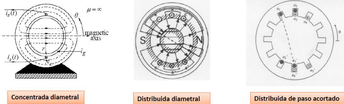
Figura 7. Ejemplo de cada tipo de devanado. [FERN14] [FRAIL03]
