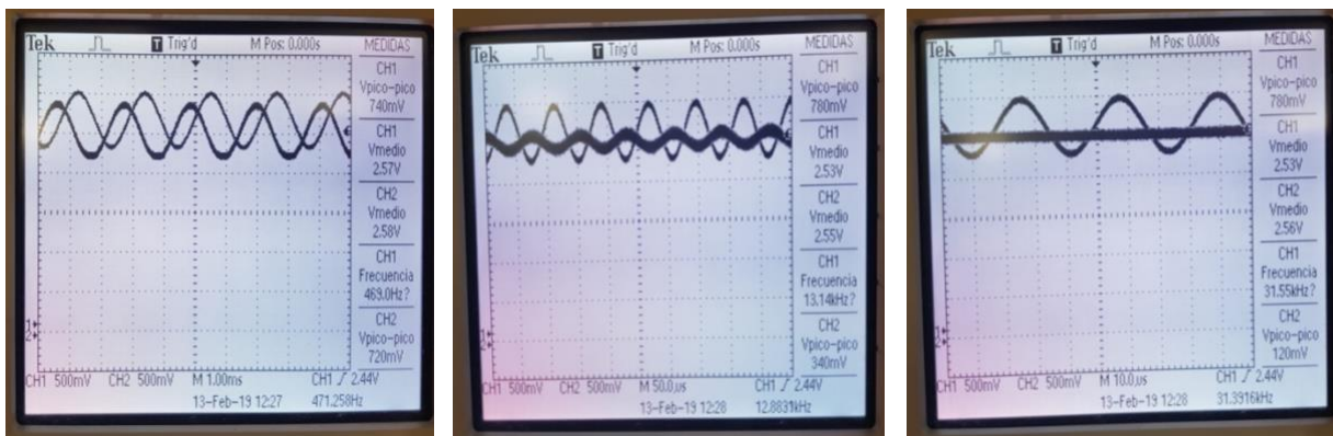
Figura 60. Filtro Anti-aliasing, BBD y Reconstrucción; baja frecuencia 500 Hz (izqda.) y media frecuencia 13kHz (medio) y alta frecuencia 30 kHz (dcha.) (fuente: osciloscopio)
