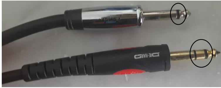
Figura 9. Cable mono (arriba) y cable estéreo (abajo) (fuente: elaboración propia)
