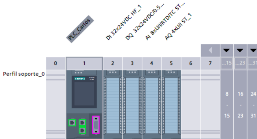
Figura 8. Componente PLC Tia Portal
