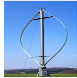
Img.41. Aerogenerador de tipo Darrieus.
