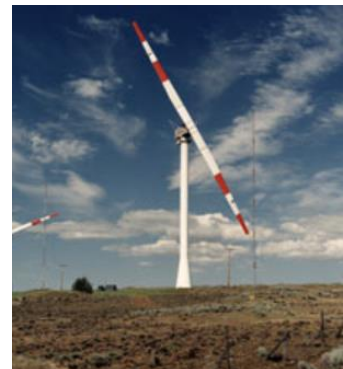
Img.46. Aerogenerador de dos palas.
