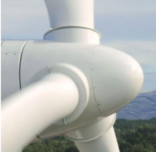
Img.36. Buje de un aerogenerador.
