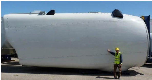
Img.39. Góndola de un aerogenerador de eje horizontal.
