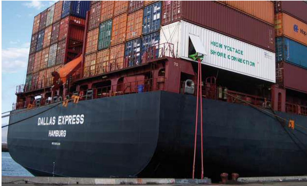
Imagen 10. Buque conectado a la red eléctrica en el puerto
