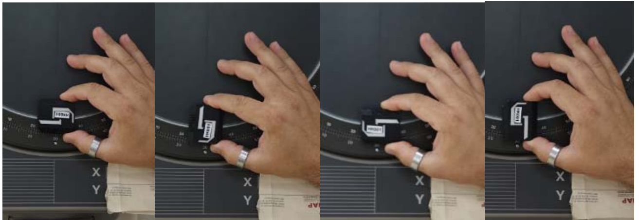
Fig. 4. Medición en el proyector de perfiles en el laboratorio acreditado de FREMAP sobre todas las caras del HAWK (sólo se muestran algunas posiciones). Fuente: Imagen propia (2018).
