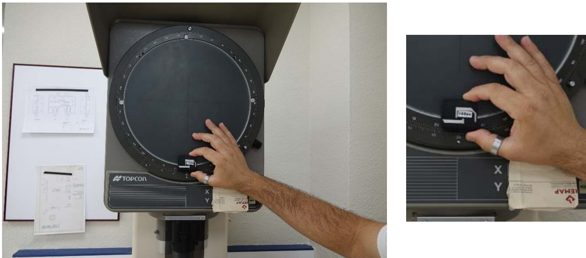
Fig. 3. Medición en el proyector de perfiles en el laboratorio acreditado de FREMAP. Fuente: Imagen propia (2018).
