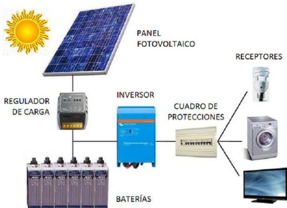
Imagen 8: Componentes de una instalación solar fotovoltaica
