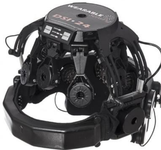
Figura 7: Dispositivo de extracción de señales EEG DSI 24
