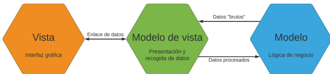
Figura 19. Esquema de funcionamiento del patrón MVVM
