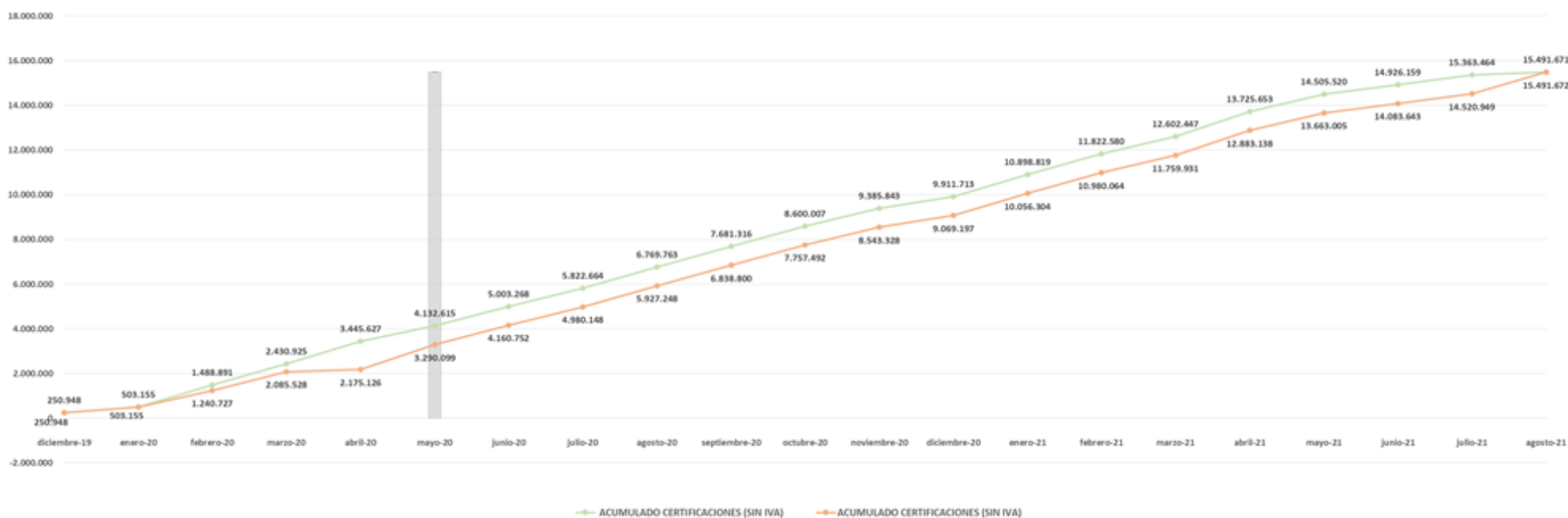
Figura 13: Representación gráfica de la variable acumulada a origen de las certificaciones de la UTE en función del tiempo, seleccionando mayo 2020 como mes de control y enero 2020 como mes de referencia. Elaboración propia.
