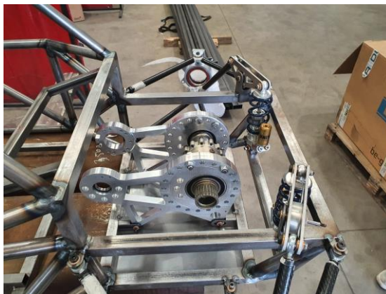
Figura 71, Soportes ensamblados en el Chasis
