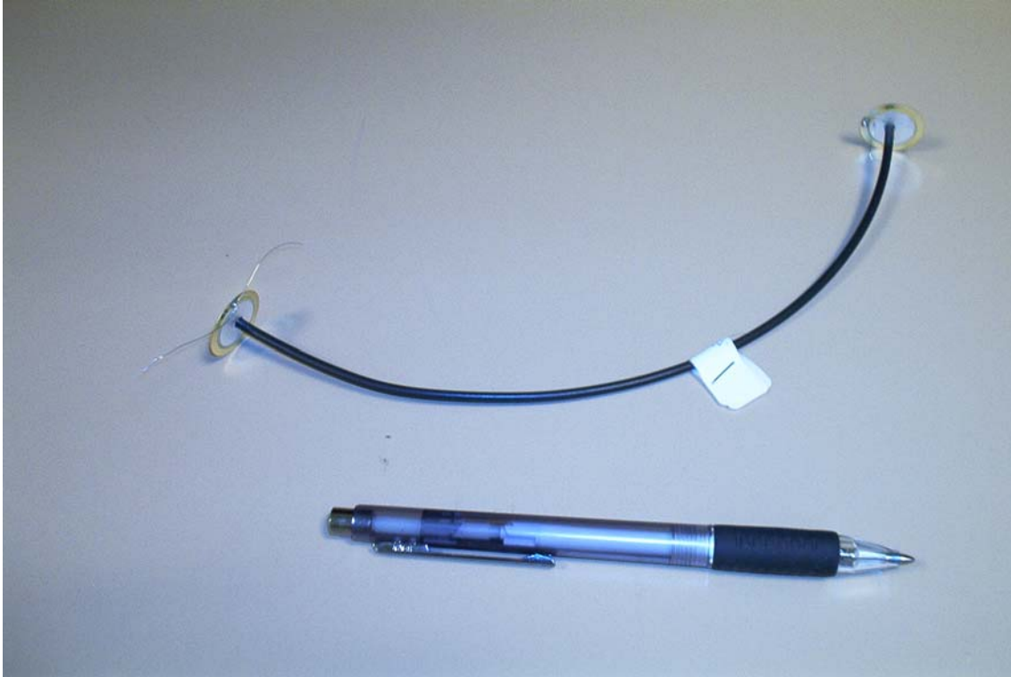
Figura 5.17. Plástico sin cobre con piezoeléctricos de baja frecuencia.
