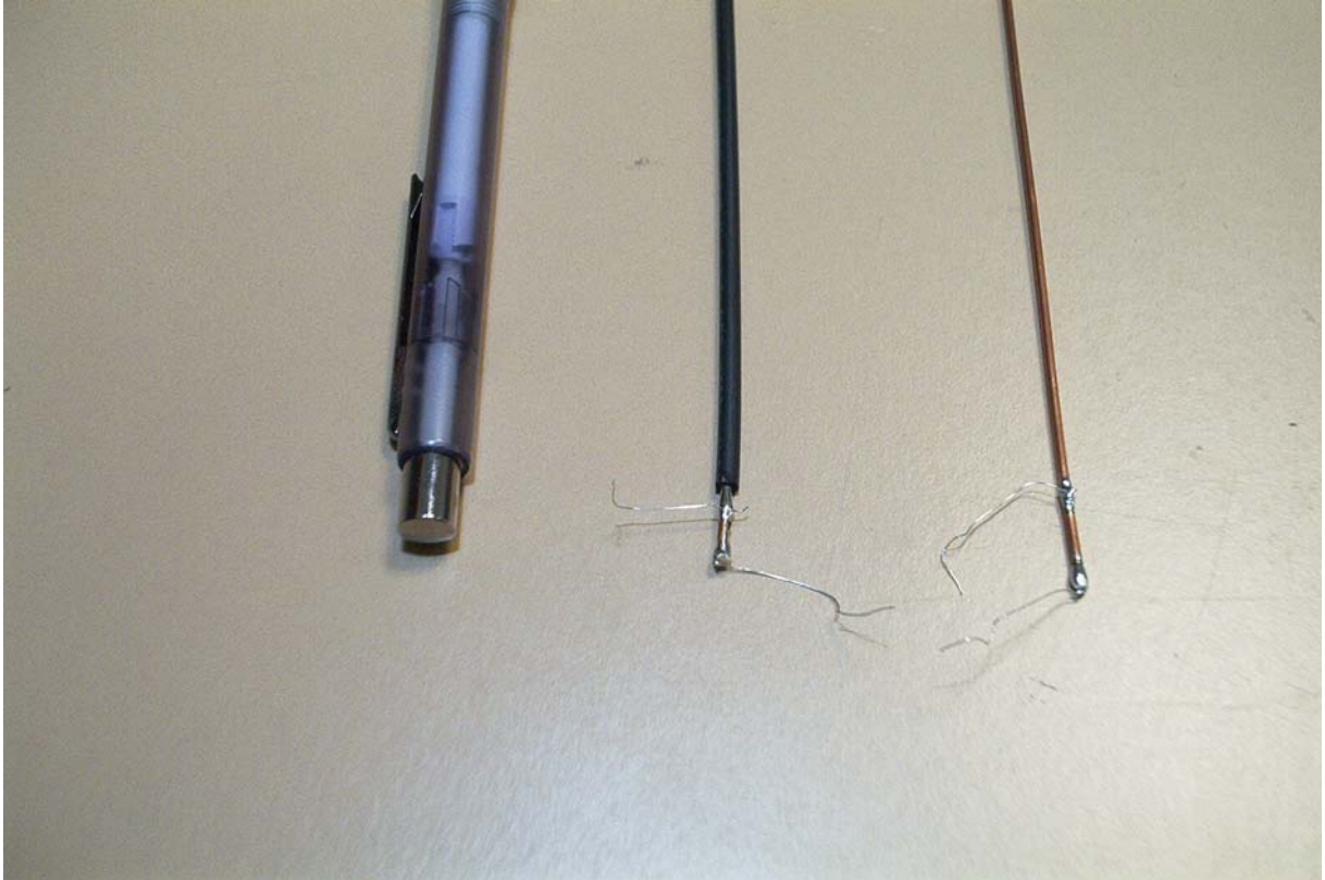
Figura 5.18. Detalle de cable de cobre con y sin cubierta de plástico, con piezoeléctrico soldado al cable y fragmentado a las dimensiones del mismo, y con cables de los electrodos, uno de ellos (el superior) soldado directamente al cable.
