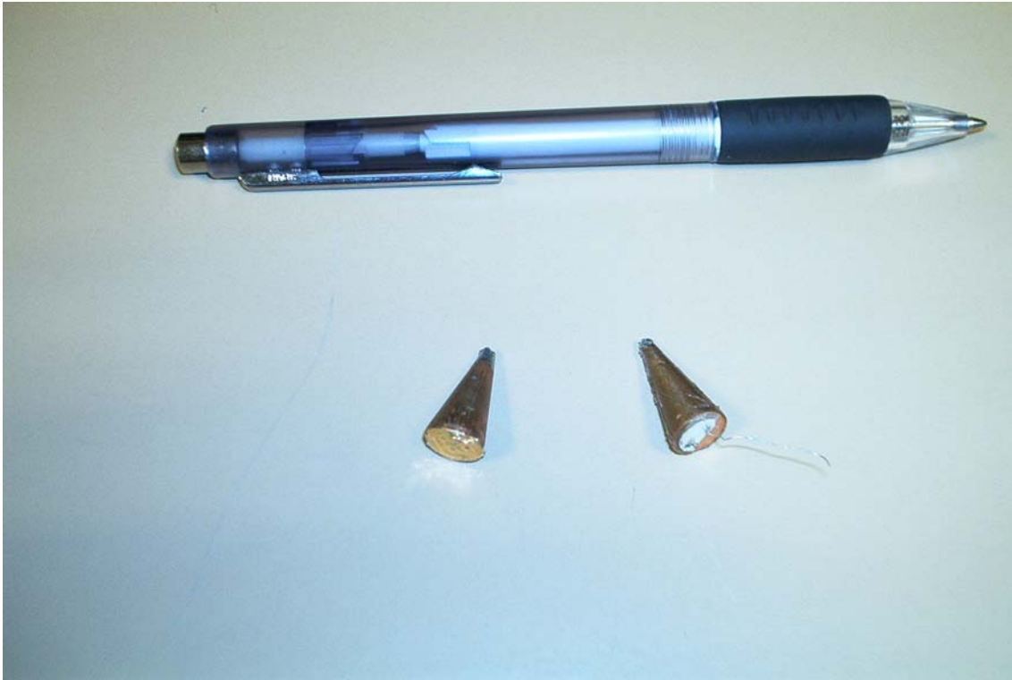
Figura 5.7. Acoplamiento cónico entre el piezoeléctrico y el cable.
