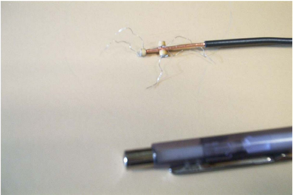
Figura 5.11. Piezoeléctricos de frecuencia de resonancia 1MHz en modo longitudinal y modo “sándwich”.
