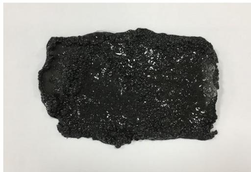
*Img. 13: Lámina de espesor variable*
