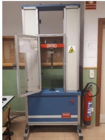
*Fig. 13: Máquina de ensayos universal*
