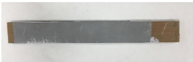
*Fig. 26: Láminas de teflón en probeta*
