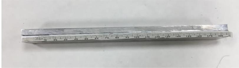
*Fig. 27: Cinta métrica en probeta*
