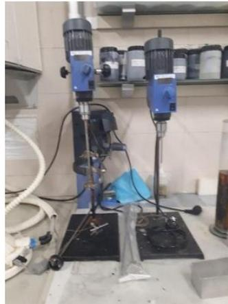
*Fig. 6: Agitador mecánico*
