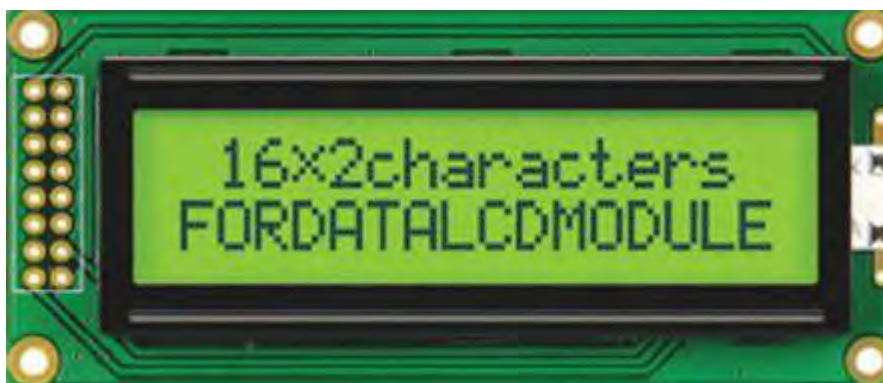
Figura 26: Imagen del LCD alfanumérico de 16x2 caracteres
