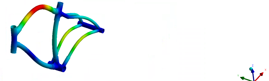
Ilustración 105: Modo 8 a 417Hz con alta participación en el eje Z
