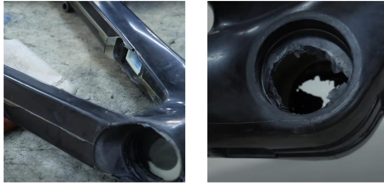
Ilustración 22: Remanentes de fibra y resina tras la curado
