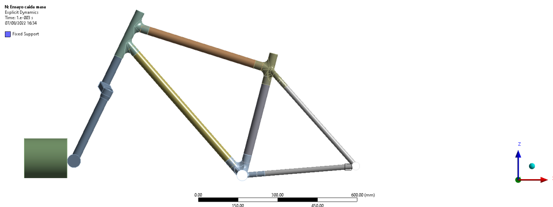
Ilustración 50: Condiciones de contorno del Ensayo 1- Caída de masa
