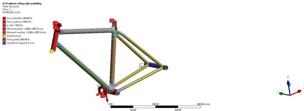
Ilustración 61: Condiciones de contorno Ensayo pedaleo en pendiente
