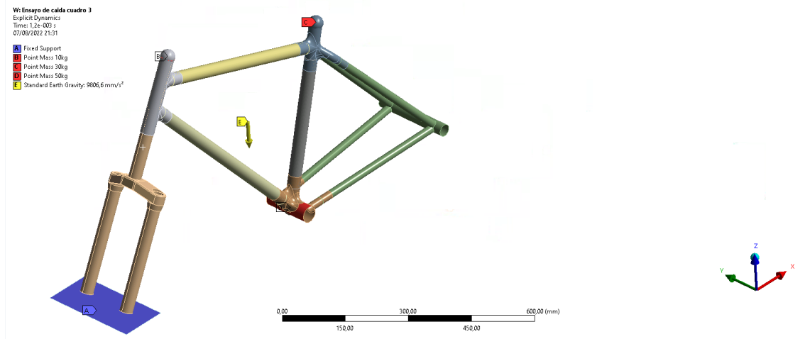
Ilustración 52: Condiciones de contorno Ensayo 2- Caída del cuadro
