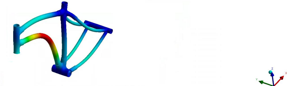
Ilustración 104: Modo 4 a 287Hz con alta participación en el eje X
