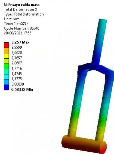
Ilustración 76: Resultado de deformación en dirección X en la horquilla- Ensayo caída masa
