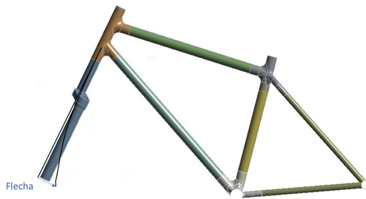
Ilustración 86: Indicación de la deformación analizada en el ensayo
