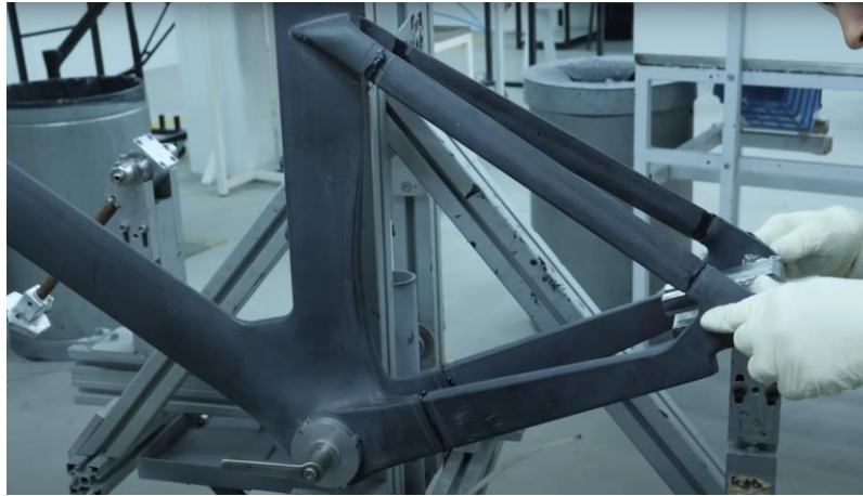
Ilustración 24: Herramienta de sujeción del cuadro durante el pegado
