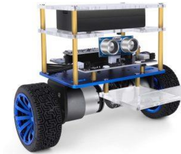
Figura 6: kit del vehiculo equilibrista Tumbler de la marca ELEGOO
