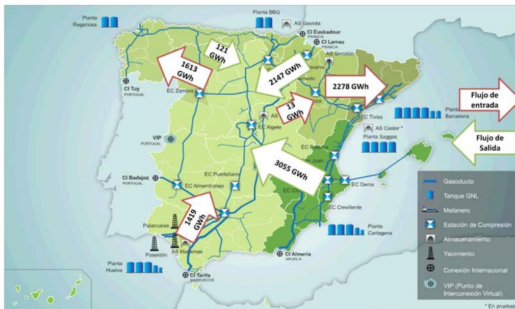
Figura 4-4 – Flujos de entrada y salida en zonas de balance.
