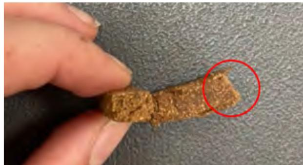
Figura 39: Probeta rota tras ensayo de flexión. Rotura frágil
