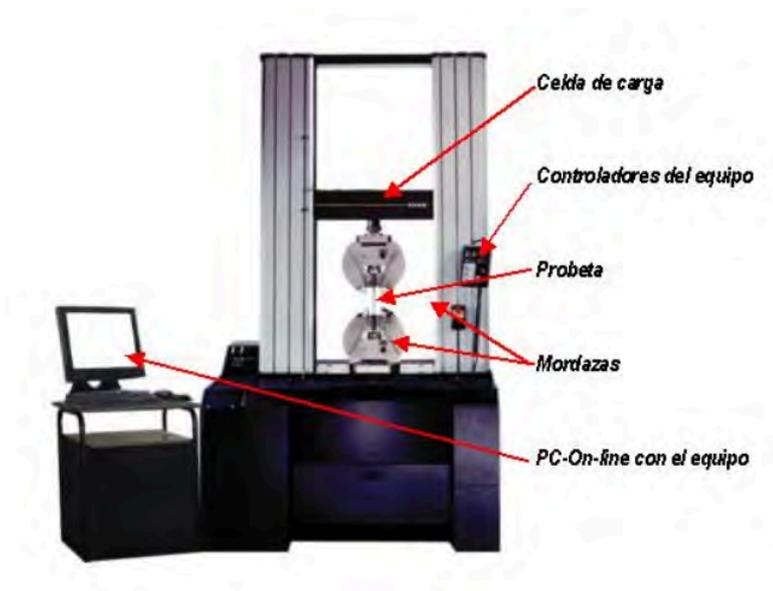
Figura 15: Esquema de una máquina de ensayos universal
