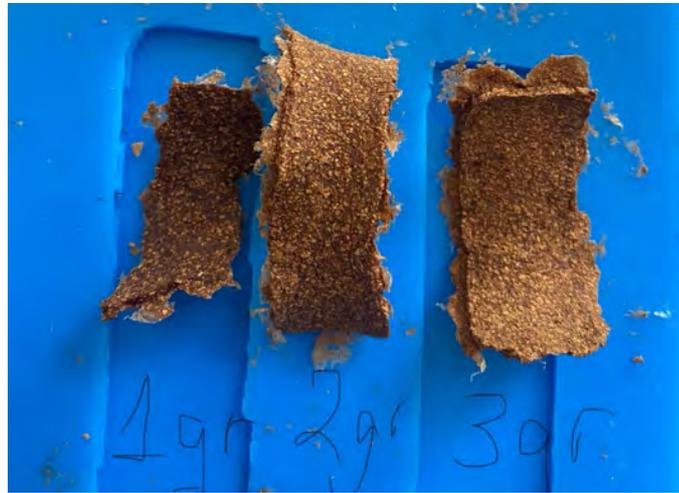
Figura 30: Probetas de alginato y cáscara de almendra en un molde de 5 mm de espesor para distintas proporciones de cáscara de almendra (1, 2 y 3 g)
