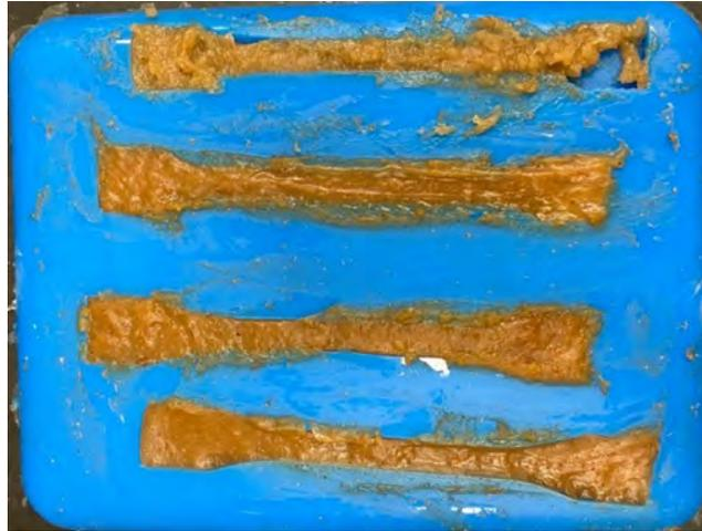
Figura 21: Probetas húmedas del bioplástico con la cáscara de almendra en polvo
