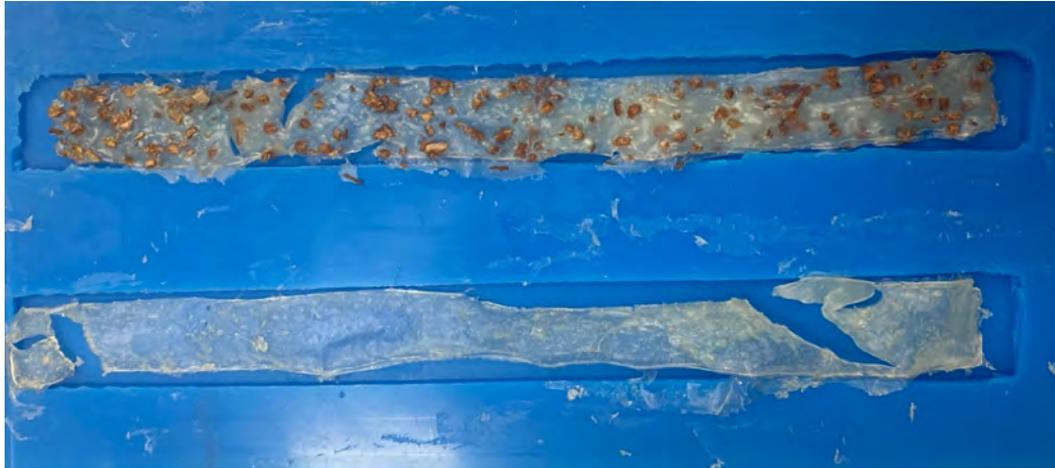
Figura 23: Comparación de probetas de bioplástico con y sin cáscara de almendra
