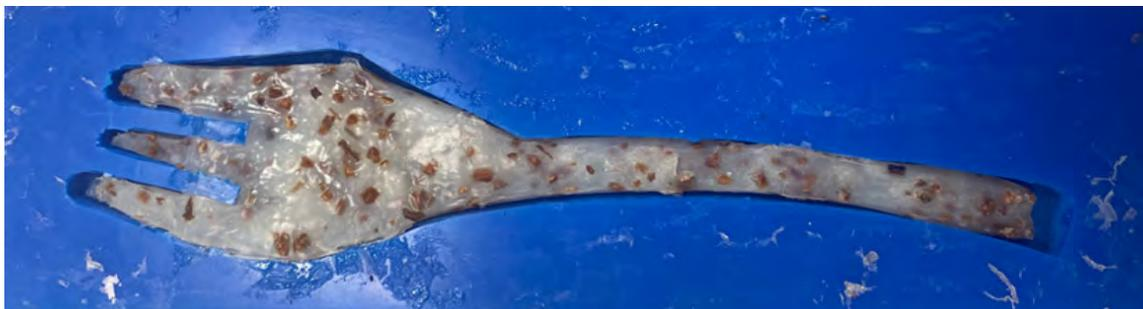
Figura 28: Prueba de alginato con almendra con un tamaño de grano de 2 mm
