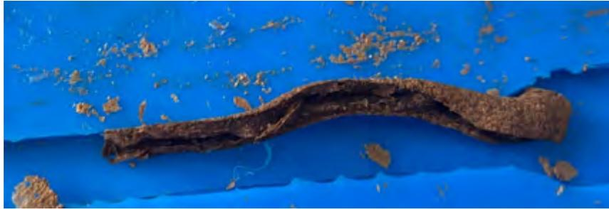
Figura 33: Probeta de alginato y cáscara de almendra secada al horno a 180 °C
