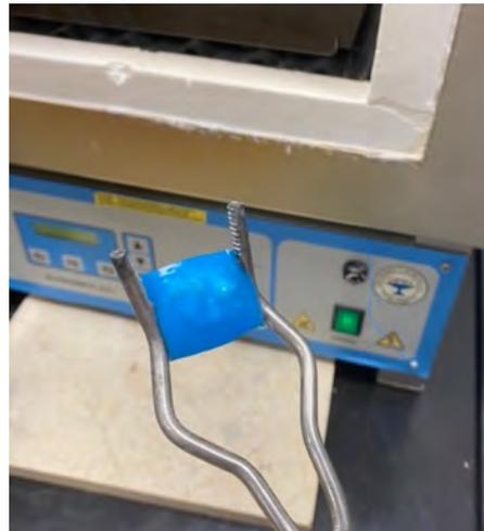
Figura 24: Trozo de silicona utilizada, sometida a 400 °C para comprobar su resistencia térmica
