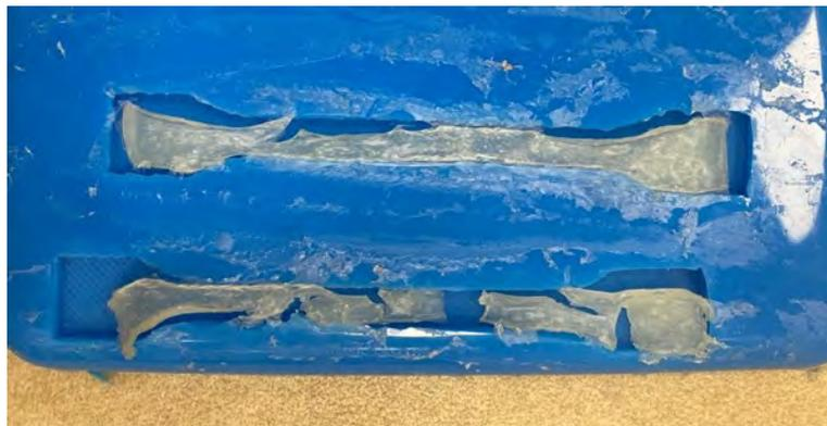
Figura 19: Probetas resultantes de un bioplástico convencional
