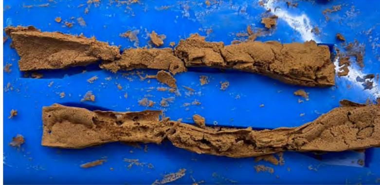
Figura 26: Probetas de arcilla con cáscara de almendra en polvo secadas en horno
