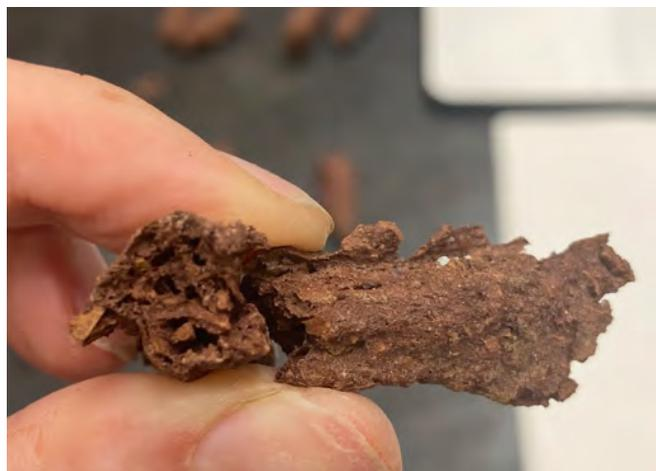
Figura 25: Probeta de arcilla con cáscara de almendra de 2 mm de tamaño de grano secada al horno
