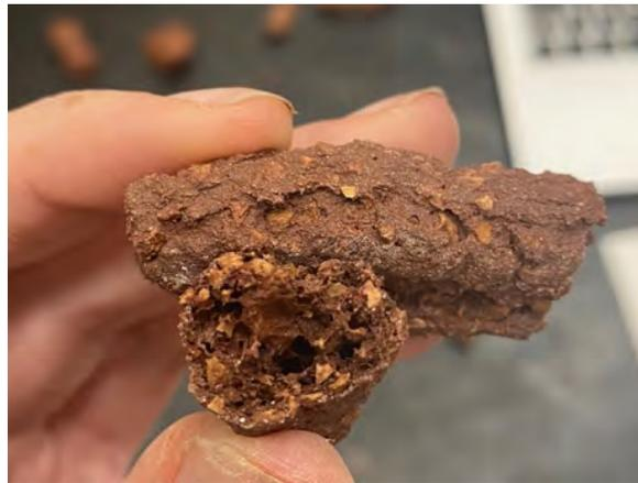
Figura 10: Probeta de arcilla y cáscara de almendra secada al horno
