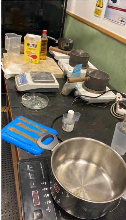
Figura 9: Disposición de materiales para la creación del bioplástico
