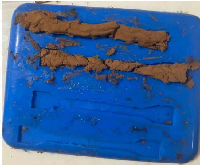
Figura 29: Probetas de alginato y cáscara de almendra mezclado de forma abrupta
