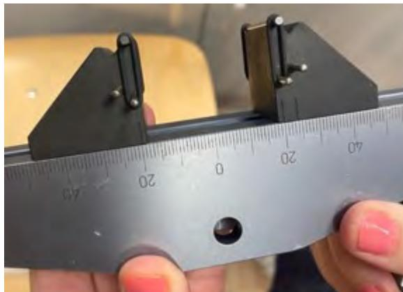
Figura 35: Distancia entre apoyos en la mordaza de la máquina de ensayos
