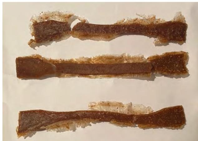
Figura 22: Probetas secas del bioplástico con la cáscara de almendra en polvo
