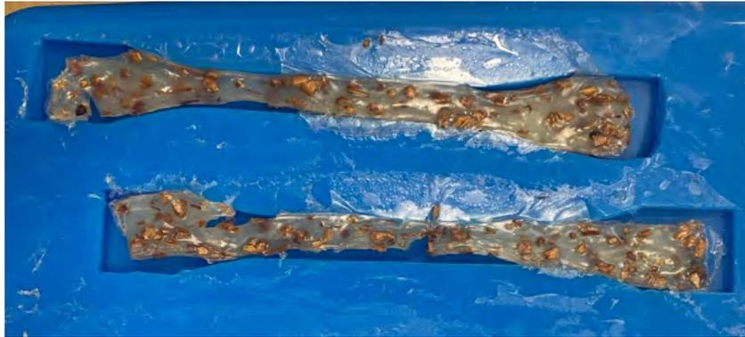
Figura 20: Probeta de bioplástico con cáscara de almendra en partículas de 2mm
