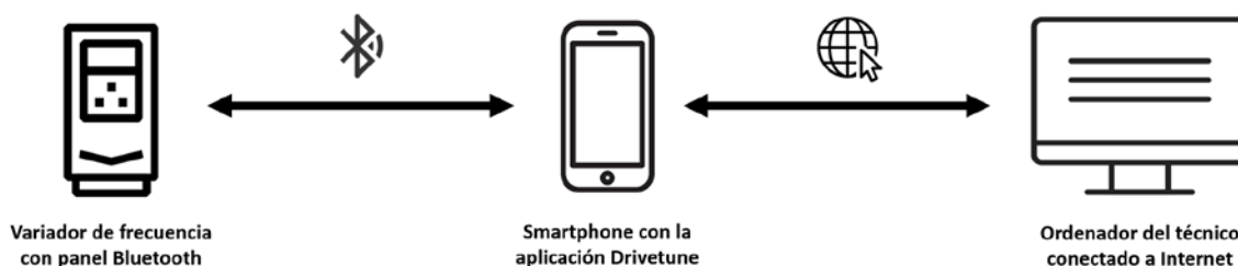
Ilustración 16: Esquema de conexiones de Mobile Connect
