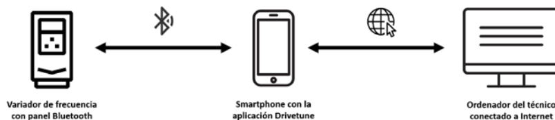
Ilustración 3: Esquema de conexiones de Mobile Connect
