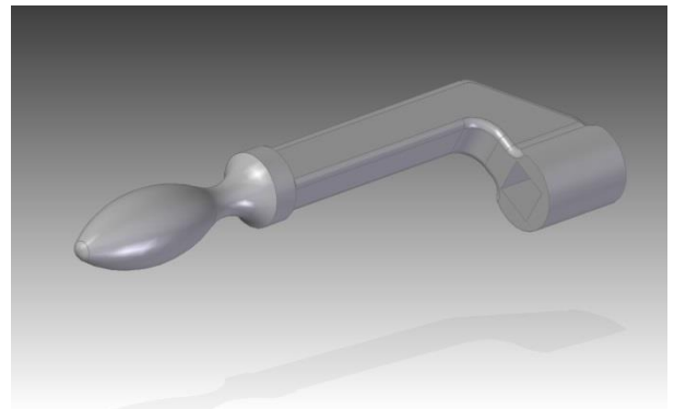
Figura 9: Detalle de la manivela que gira el tornillo espiral.
