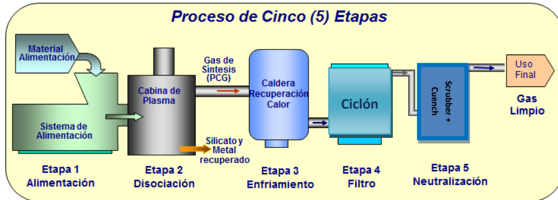
Figura 27. Etapas del proceso de gasificación por plasma. [16]
