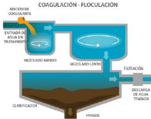
Figura 17. Coagulación, floculación y decantación (CFD)
