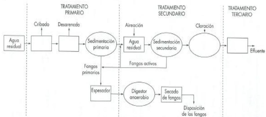
Figura 8. Tratamiento primario, secundario y terciario de las aguas residuales urbanas.
