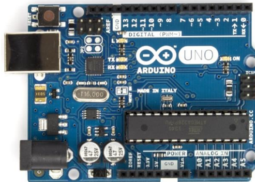
IMAGEN 3 | TARJETA ARDUINO UNO
