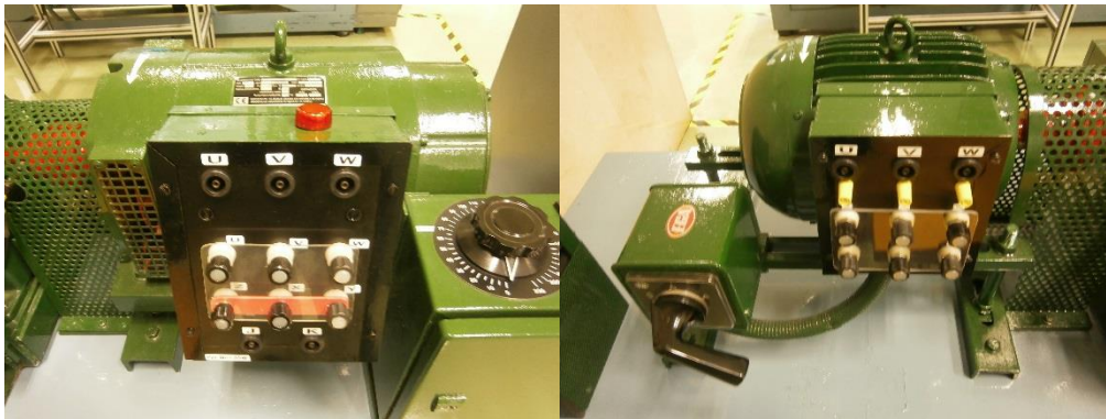
IMAGEN 5 | MÁQUINA SÍNCRONA (IZDA.) Y ASÍNCRONA (DCHA.) DEL GRUPO 5 DEL LABORATORIO DE MÁQUINAS ELÉCTRICAS DEL ICAI
