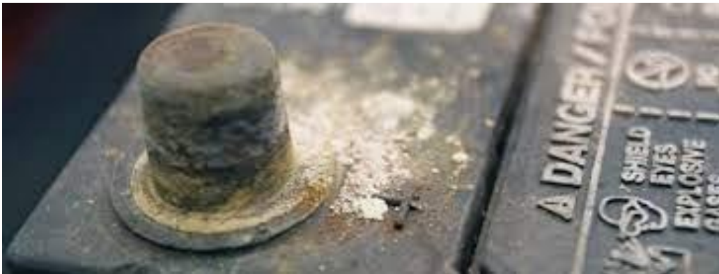
Ilustración 29: Ejemplo de sulfatación en una batería. Fuente [29]
